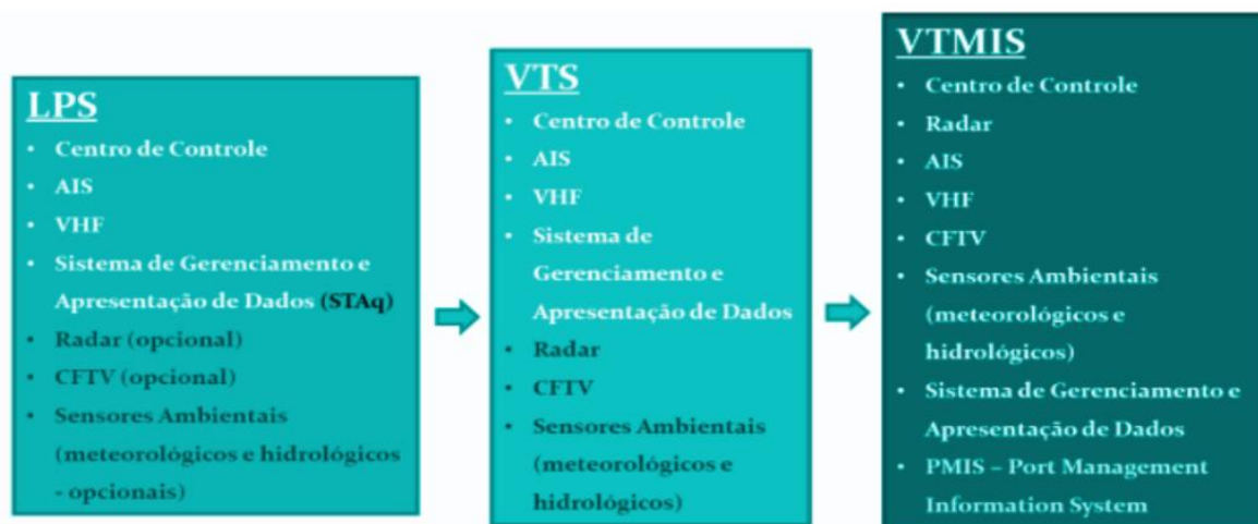
Figura 2 - Diferenças entre os Sistemas de Monitoramento de Embarcações
